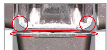
Herkömmlich Starke Aufbauschneidenbildung
