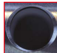
Über 200 Bohrungen Gute Oberflächenbeschaffenheit und kein Werkzeugverschleiß
