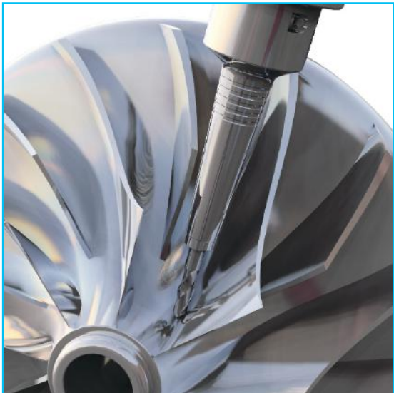
5-Achsbearbeitung mit Kugelfräser Finishing with ball endmill on 5-axis machine
